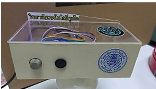
ภาพที่ 1 อุปกรณ์ตรวจจับและแจ้งเตือนแก๊สรั่วไหล
