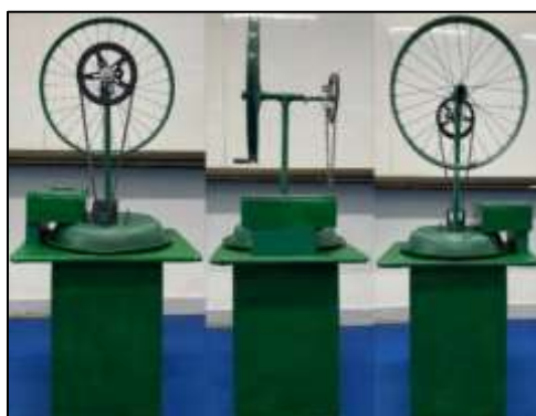
ภาพที่ 6 โครงสร้างชุดชาร์จแบตเตอรี่โทรศัพท์มือถือจากชุดออกกำลังกาย
