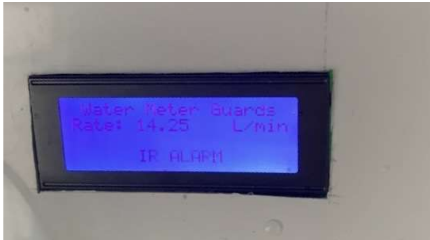
ภาพที่ 4 จอ LED แสดงผลการวัดอัตราการไหลของน้ำ
