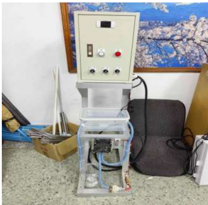
ภาพที่ 6 โครงสร้างเครื่องเพาะพันธุ์ปลานิลแฉ่งเดือนอุณหภูมิจากน้ำ
