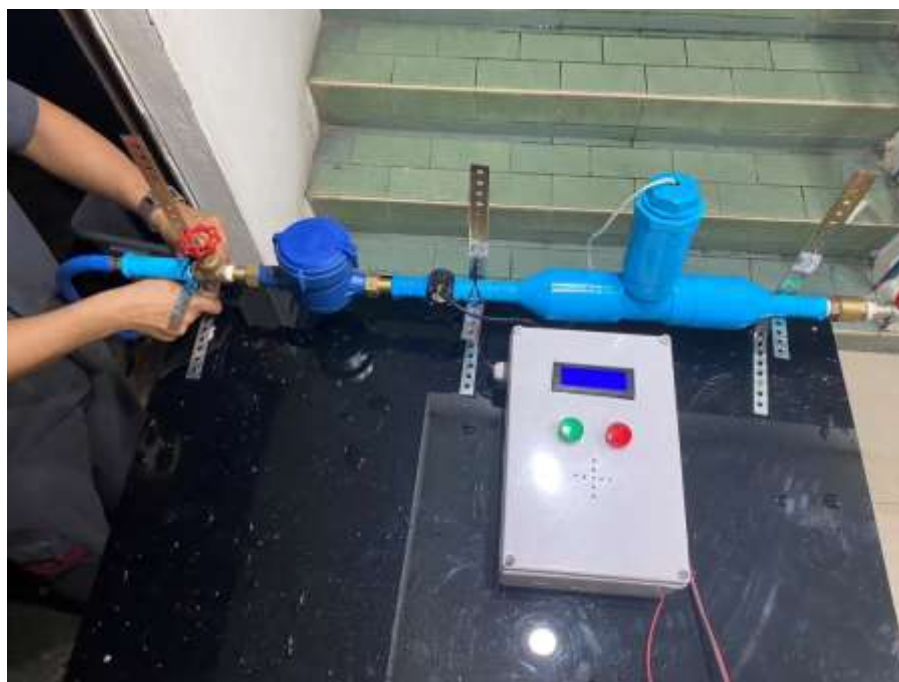
ภาพที่ 3 เครื่องป้องกันมิเตอร์น้ำหายแจ้งเตือนผ่านแอปพลิเคชันไลน์
