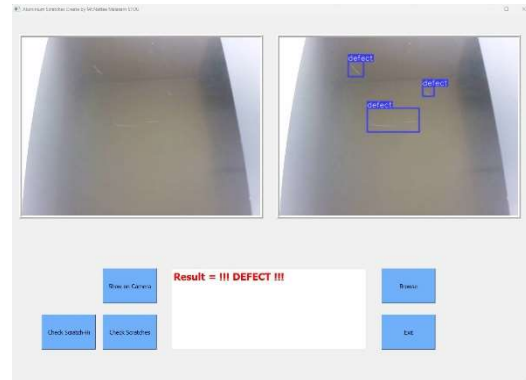
ภาพที่ 2 : ผลลัพธ์การตรวจสอบชิ้นงานที่มีรอยขีดข่วน
